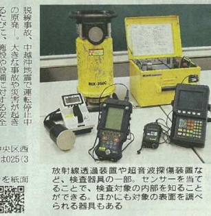
放射線透過装置や超音波探傷装置など、検査器具の一部。センサーを当てることができ、検査対象の内部を知ることができる器具もある
