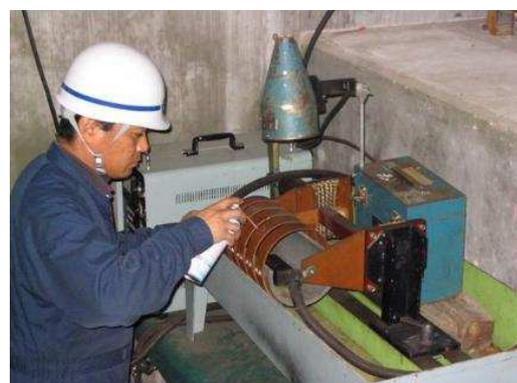
小型部品の磁粉探傷試験(コイル法)
