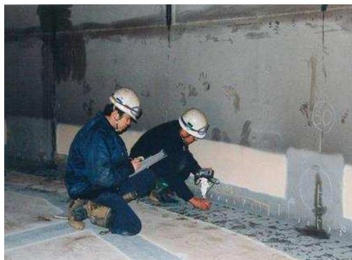
屋外貯槽タンク底板の厚さ測定
