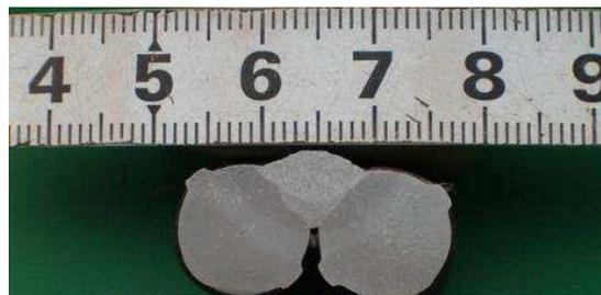
フレア溶接、各種溶接部の溶込幅、積層数の確認が出来ます。
