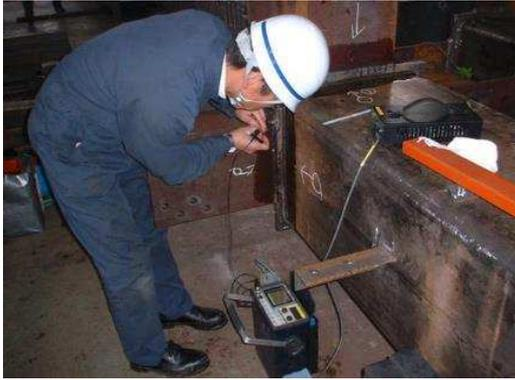
鉄骨溶接部の超音波探傷試験
