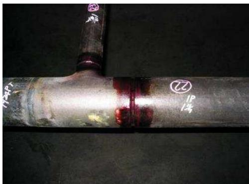
配管の初層溶接部、浸透状況
