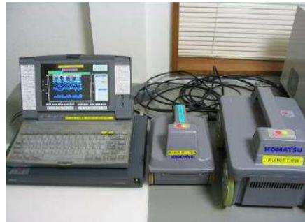
コンクリート構造物内部検査装置
