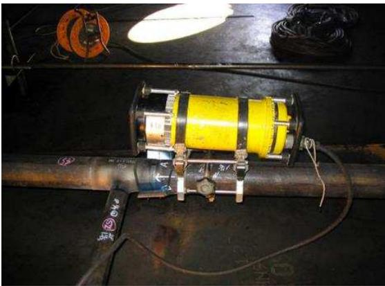
配管溶接部の放射線透過試験
