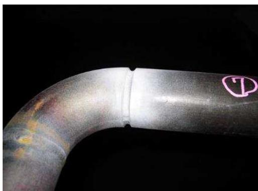
配管の初層溶接部、現像状況
