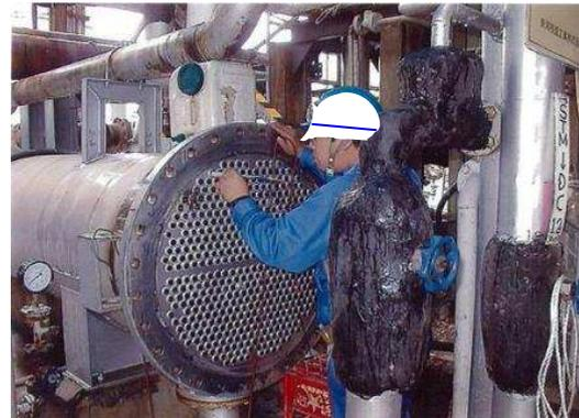
熱交管板チューブの超音波探傷試験
