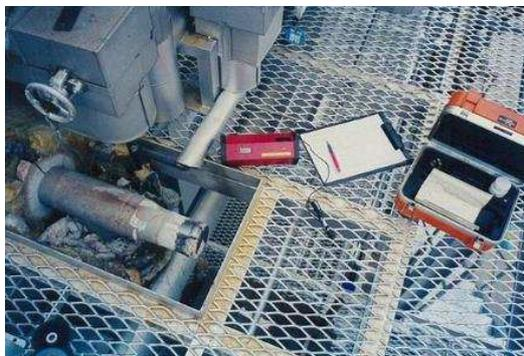
溶接完了後や焼鈍後の硬度を測定します。
