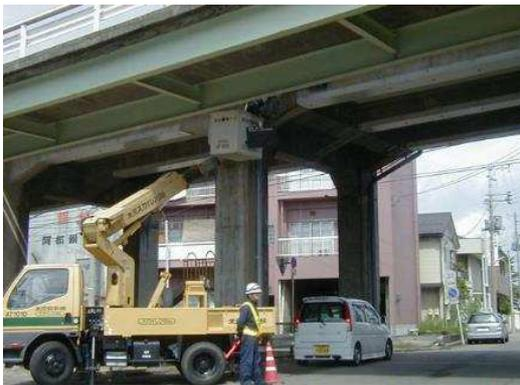
落橋防止装置のアンカーボルト長測定
