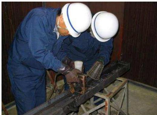
吊金具等の磁粉探傷試験
