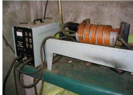
小型定置式磁粉探傷試験装置
