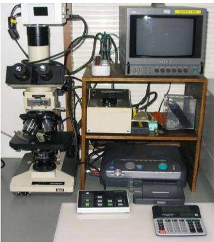
金属組織検査用光学顕微鏡,モニター類
